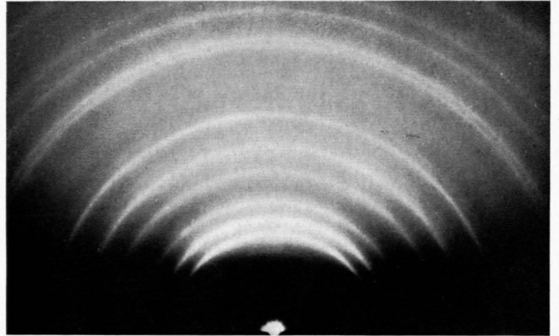
Abb. 2. Diagramm von kathodenzerstäubtem Silber, das ein Gemisch von Ag und \text{Ag}_2\text{O} darstellt. Es entsteht durch Erwärmen des Präparates von Abb. 1 im Vakuum bei 150^\circ\text{C} , wobei sich durch thermische Zersetzung von \text{Ag}_2\text{O} ein Gemisch aus \text{Ag}_2\text{O} und Ag bildet.
